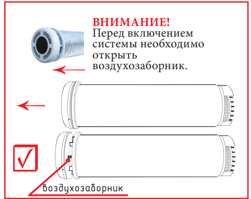
Рис. 7. Запуск системы вентиляции.
