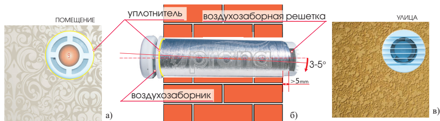
Рис. 3. Схема установки «PRANA-150», «PRANA-200G», «PRANA-200C» в стене: а) вид вентиляционной решетки изнутри помещения (фронтальный разрез); б) размещение системы в стене (продольный разрез); в) вид вентиляционной решетки с улицы (фронтальный разрез).
